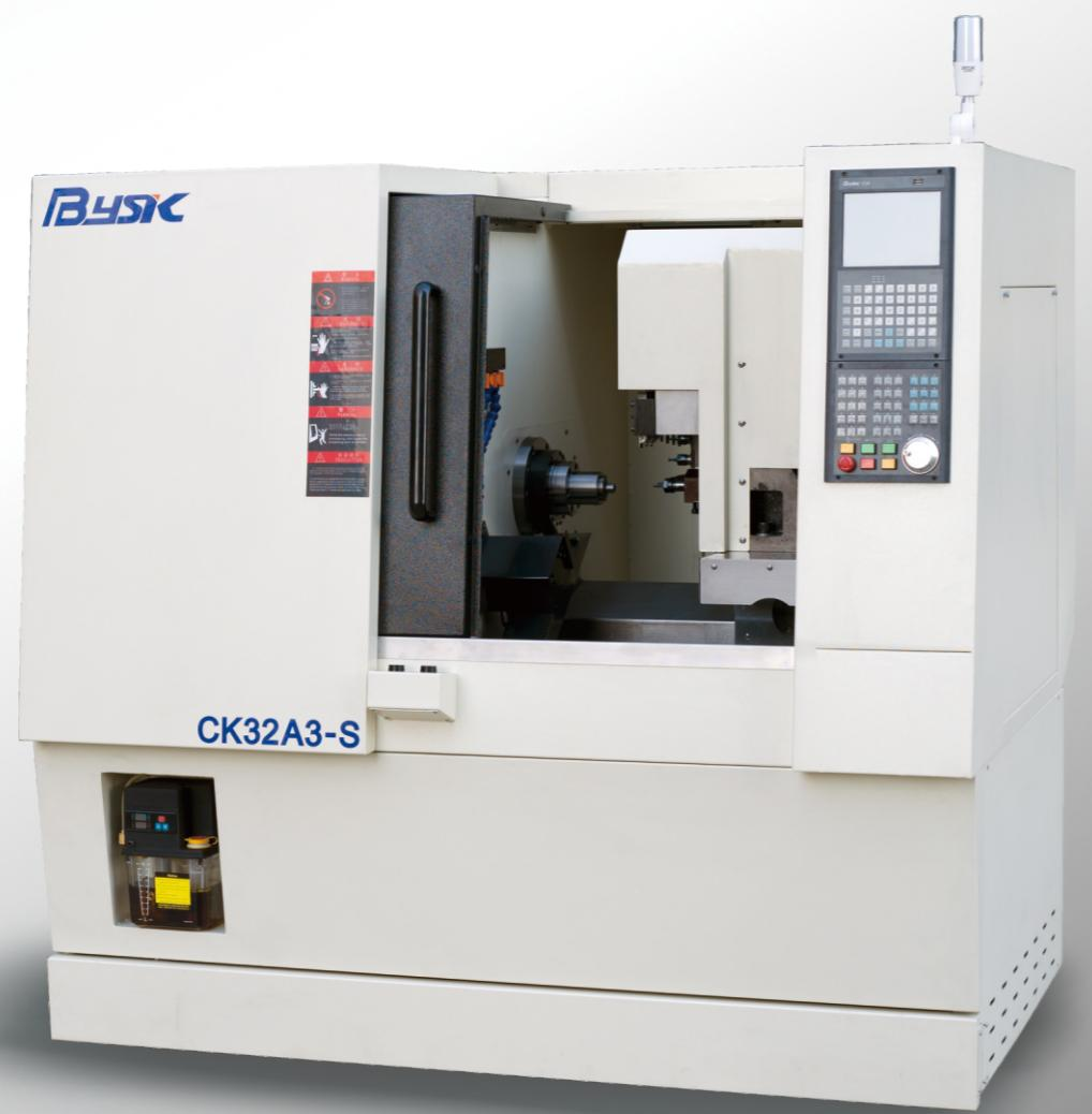
平床身数控排刀车床。在其基础上可根据零件不同的生产需求。选择配置成车铣复合车床和双主轴数控排刀车床。其结构形式是在拖板上增加一个Y轴及侧铣动力刀头或端面动力头，可满足车削、铣削复合化加工需求。另可在小拖板上增加一个副主轴，并在机床主轴箱侧面固定一个Y轴、副轴刀座及切断刀座，可实现工序的自动交换及二道工序加工，配备自动送料机更可以实现全自动加工。既保持了排刀车床刚性好、切削精度高的特点，又解决了工件在一次装夹下的二道工序加工问题。
